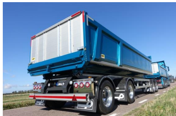
Automatläm 250 mm pneumatisk. Kombigångjärn till lucka, högerhängd.
