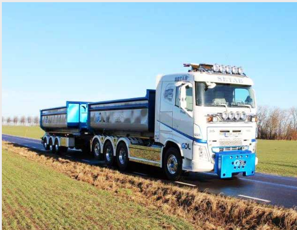
Läckert ekipage! Volvo FH 540 8x4 utrustad med VDS styrning, 33 tons boggie, VDL lastväxlare, ReCodrive, plogfäste, samt förberedd för Sprider. Påbyggd av CMT som även fixat flak samt jigg.
